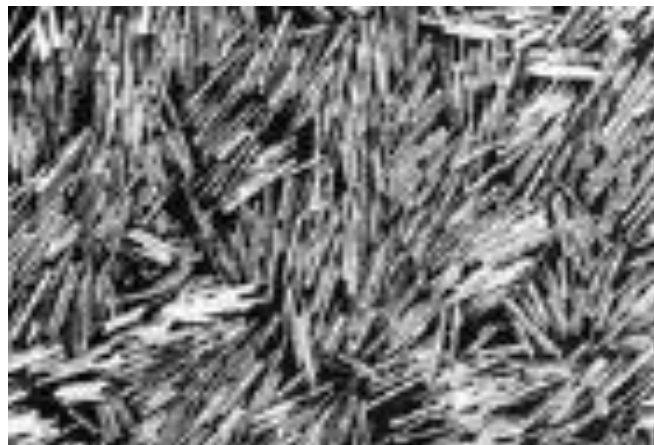
Figura 1. Cemento en escala nanométrica. Líneas blancas C-S-H, fondo negro solución de hidróxidos [10].
