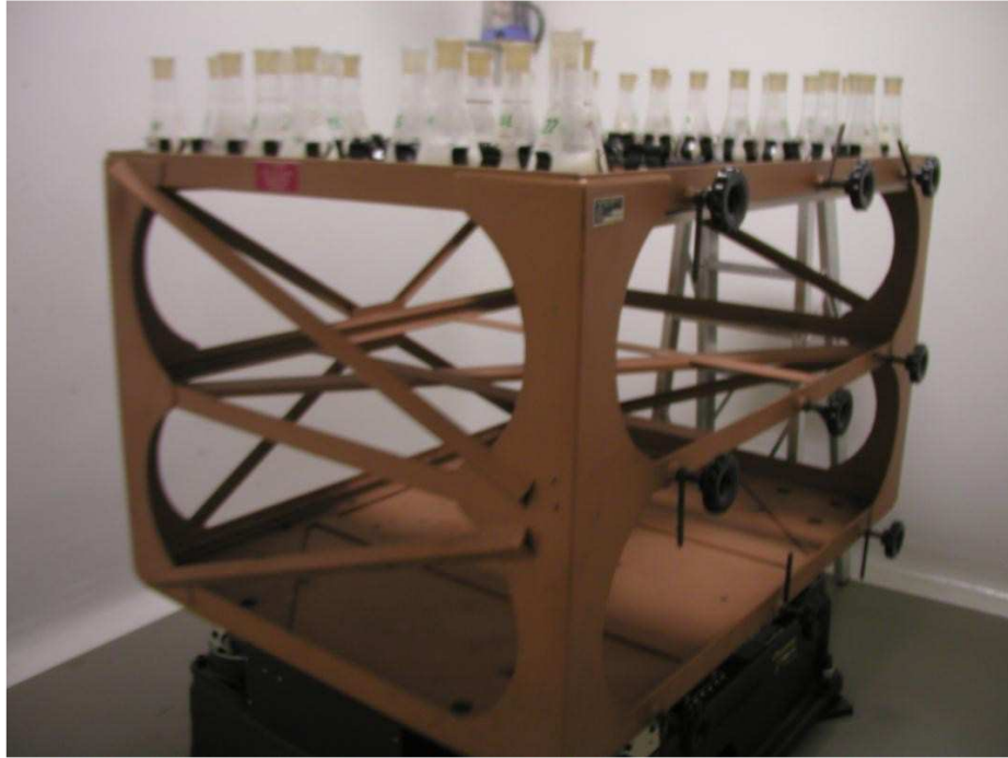
Figura 2-1: Agitador Orbital. Cuarto con temperatura (34.5°C) y humedad relativa (60-70%) controladas.
