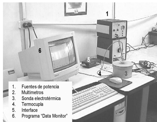
Figura 2. Montaje del sistema para evaluar la conductividad térmica del suelo ( \lambda ) (Laboratorio Física Ambiental, Univalle, 2001).
