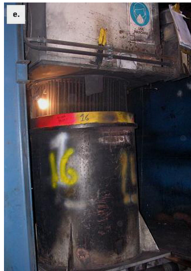
e) Llenado y moldeo con arena seca
