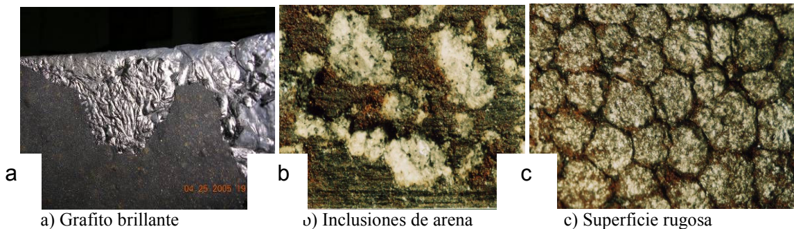
Figura 3. Defectos debidos al proceso de fundición Figure 3. Defects caused by the foundry process
