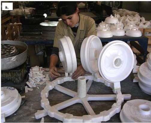
a) Ensamble de árbol con modelos en EPS
