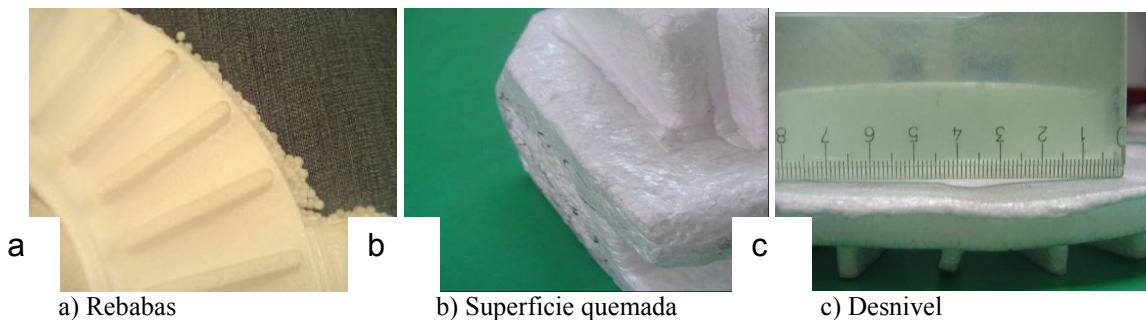
Figura 2. Defectos típicos en los modelos de espuma de poliestireno: Figure 2. Typical defects of polystyrene foam patterns
