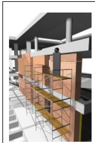
Perspectiva con los elementos del MDC parcial de mampostería del proyecto piloto.
