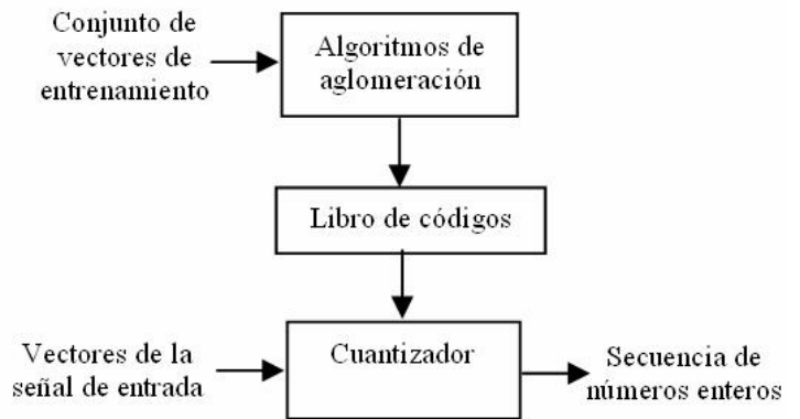
Figura 3. Diagrama de bloques de la estructura de entrenamiento y clasificación básica del VQ.
