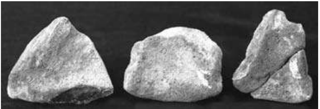
Figura 13 Embudos de fundición cerámica del grupo Friable
