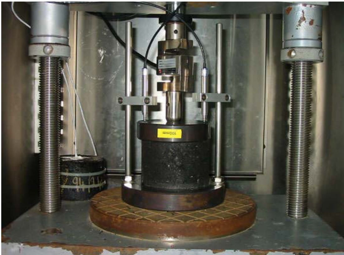
Figura 2. Montaje Briqueta para el Ensayo Creep
