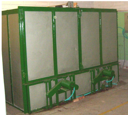
Figura 3. Horno para secado de Maderas – Laboratorio de Productos Forestales UNV.
