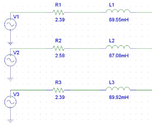
Figura 31. Circuito simulación Motor 2
