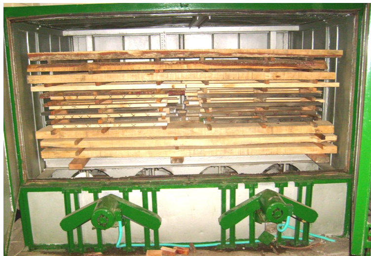
Figura 4. Pila del Horno – Laboratorio de Productos Forestales UN.
