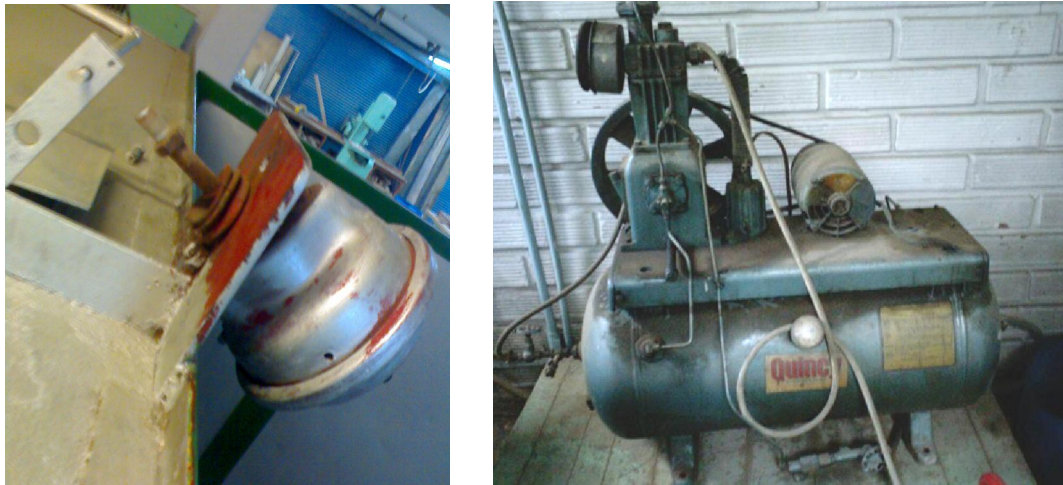
Figura 22. Actuador y Compresor Neumático sin acoples.
