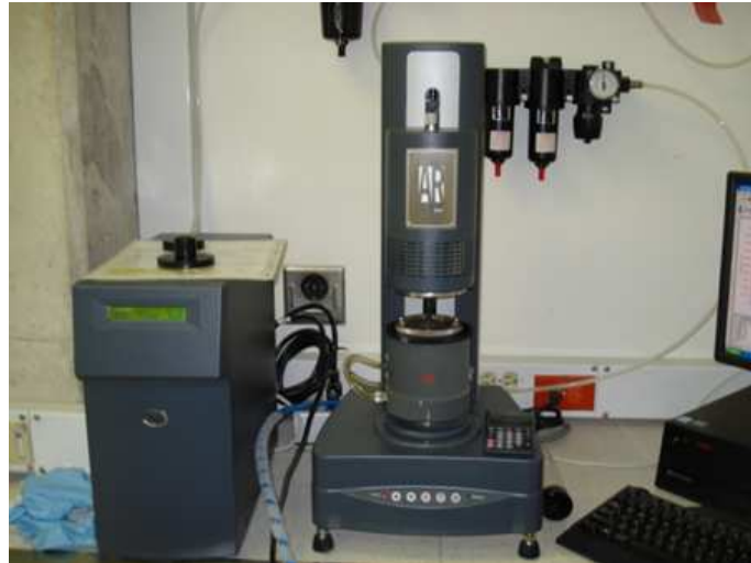
Anexo 17. Reómetro AR 2000 Utilizado Para pruebas Reológicas.
