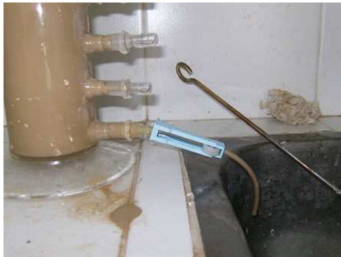
Anexo 16. Probeta con perforaciones para medir humedad
