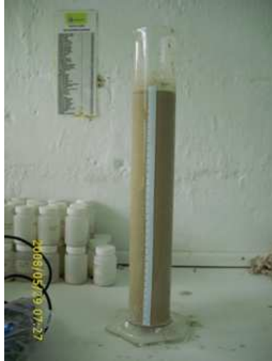
Anexo 15. Probeta graduada en mm para pruebas de sedimentación
