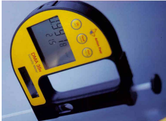
Anexo 18. Medidor de Densidad para la Medición de Humedad en la Pasta
