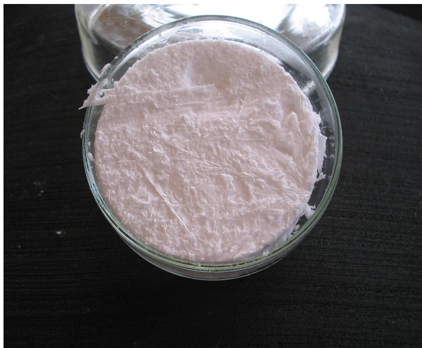
Figura 7. Enzima liofilizada con sulfato de sodio.
