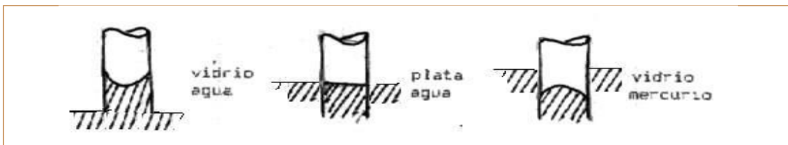
Figura 128. Meniscos. 1. Adhesión > cohesión, 2. Adhesión = cohesión, 3. Cohesión > adhesión. Tomado de Juárez y Rico. Mecánica de Suelos.
