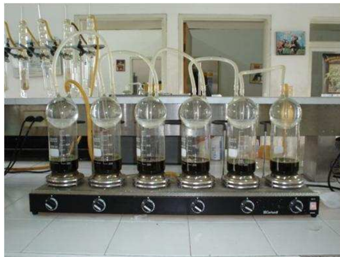
Figura 9: Digestor para fibras Gerhardt en la digestión del contenido de las jeringas con solución detergente neutra.
