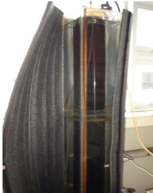
Figura 9. Cubierta de espuma del reactor
