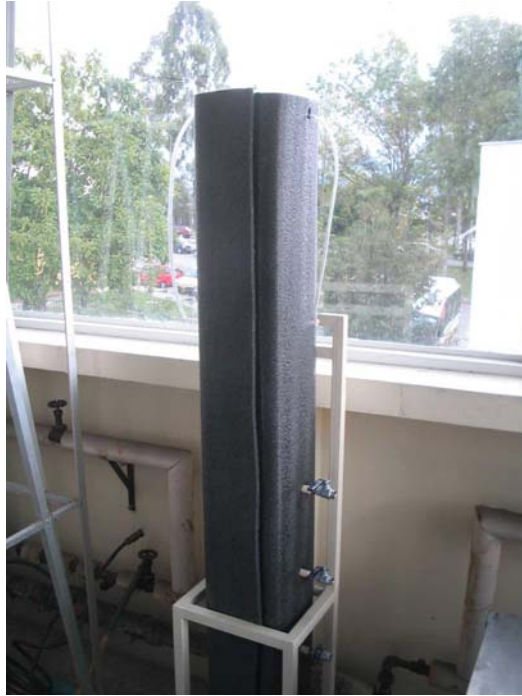
Figura 8. Reactor UASB piloto.
