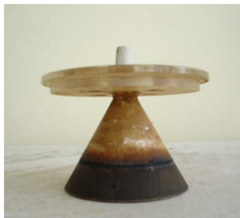
Figura 4. Campana Separadora del reactor piloto.
