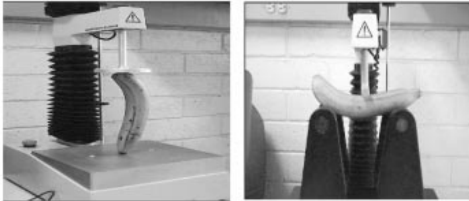
Figura 6. Prueba de fractura a compresión y flexión en banano var. Cavendish Valery.
