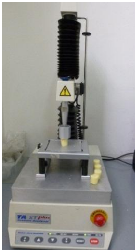
Figura 3-6. Análisis de perfil de textura de quesos mediante texturómetro TA-XT plus .
