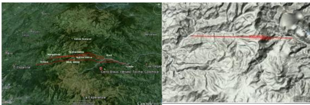
Alternativas para el Túnel Cumanday a altitudes diferentes; y Túnel Cumanday corto de 17 km a 2200 msnm.
