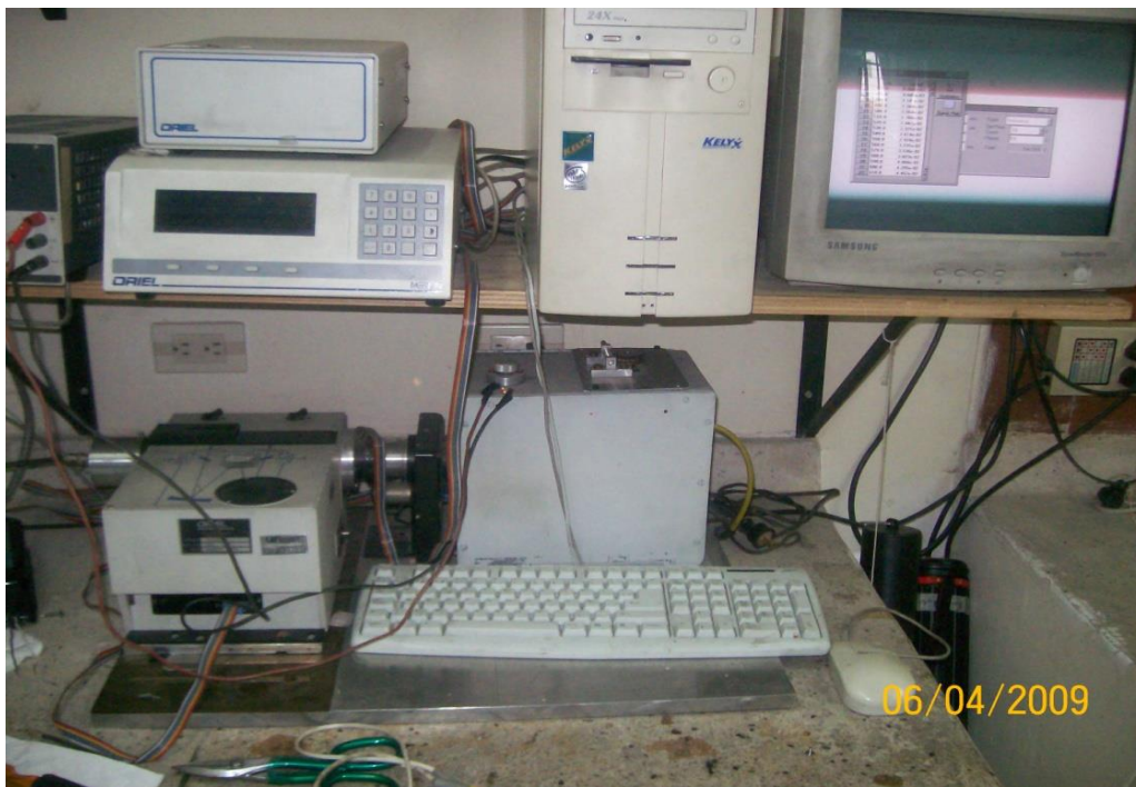
Figura 4. Equipo de espectrofotometría marca ORIEL utilizado en las mediciones de transmitancia espectral.
