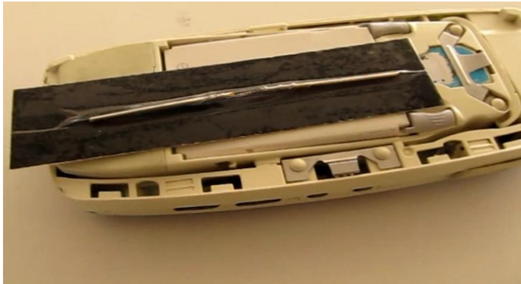
Figura 4-4 Forma de poner las antenas en los celulares.
