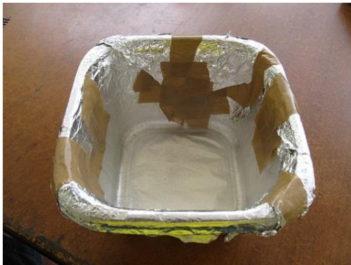
Figura 4-8 Experimento de la Jaula de Faraday.
