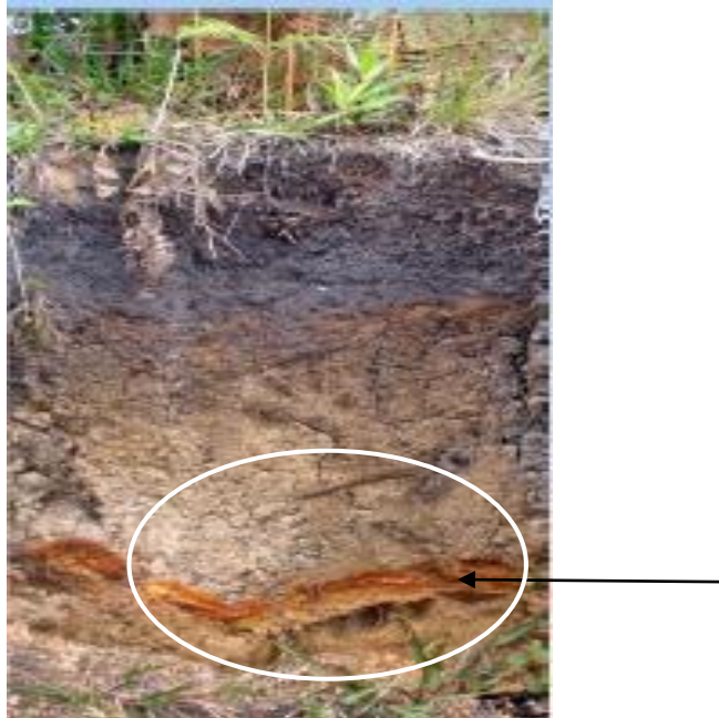
Figura 2a: Posibles restricciones en el suelo para el desarrollo forestal. Nótese Línea roja al interior del suelo que corresponde a una cementación por hierro
