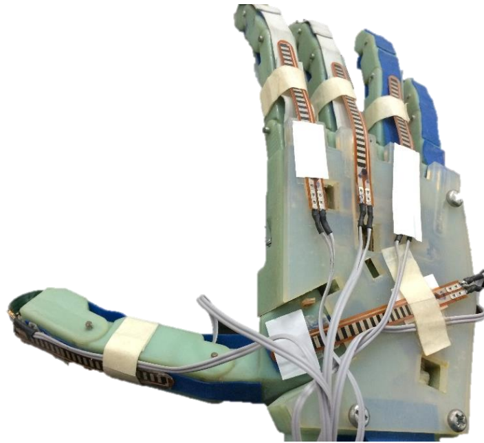
Figura A. 4. Sensores de flexión resistivos para el control de movimiento de los dedos.
