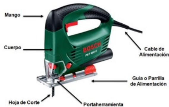
Figura 10. Partes de una caladora.
