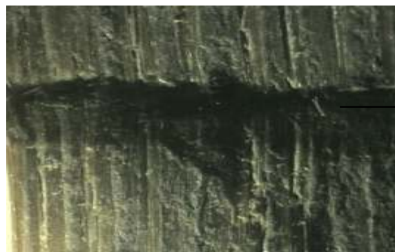
Figura 51. Falla por aplastamiento en la zona total
