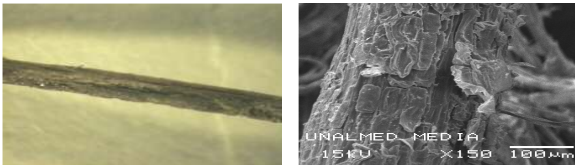
Figura 33. Fibras de la GAK. En el extremo de las fibras, se observa que estas están formadas por unidades menores denominadas células de fibras, que se hallan en tamaños largos y cortos (ver Figura 34).
