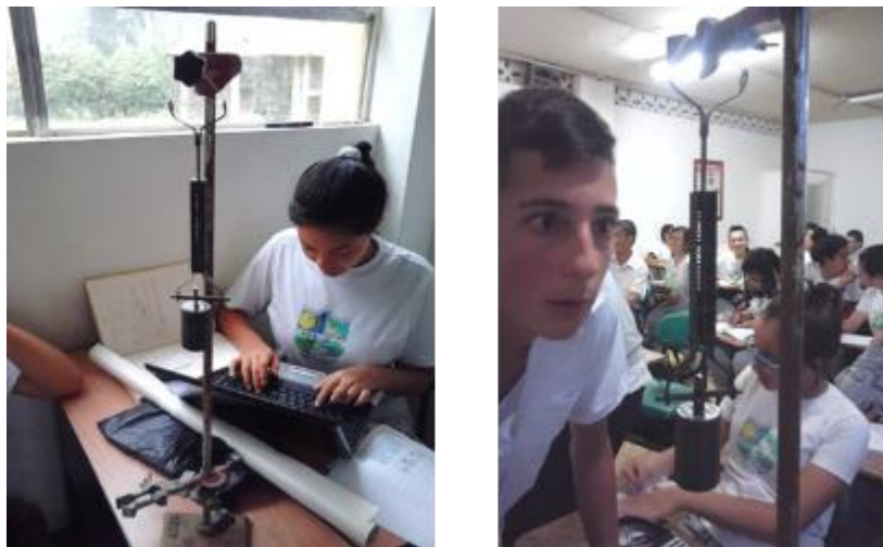
Figura 5-20. Encontrando la constante de elasticidad de un resorte.
