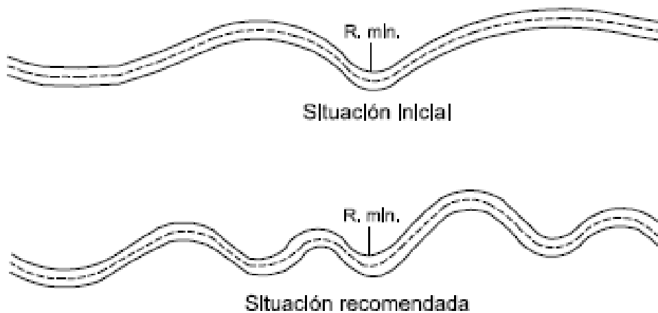
Figura 14. Transición de geometría en sitio con radios cercanos o iguales al mínimo
