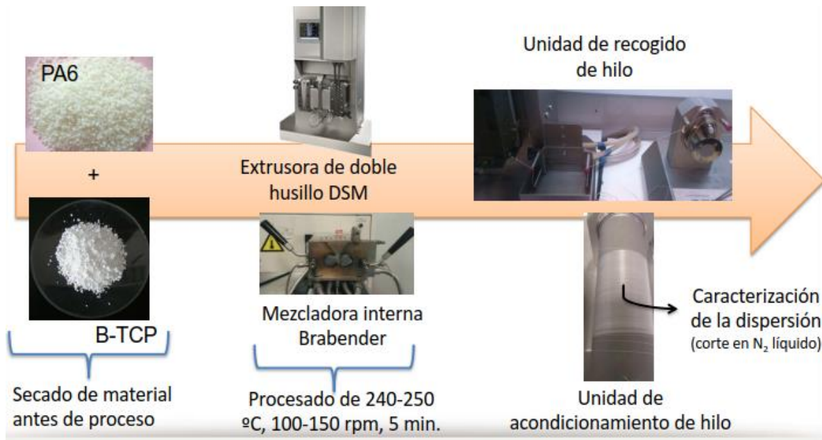
Figura 3.2 Metodología de conformación del parche mediante hilado por extrusión de doble husillo
