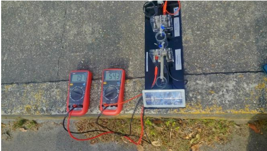
Figura 3-11 Medicion de la corriente de la celda expuesta a la luz sol
