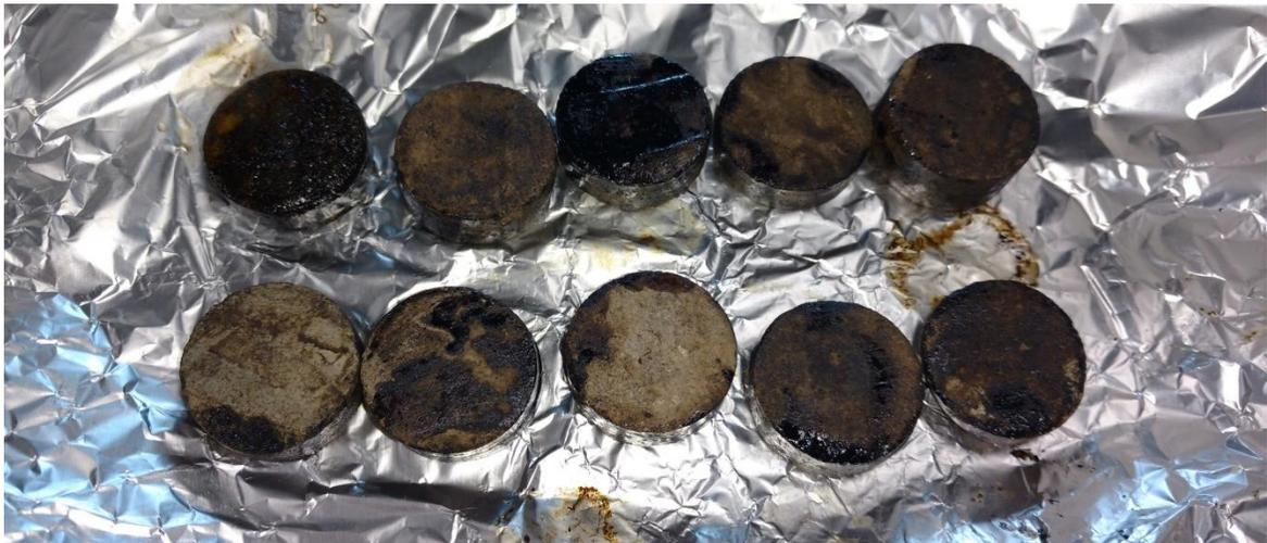
A cada uno de los 18 núcleos se le realizó pruebas de ángulo de contacto posteriores a someterlos al proceso de daño; tal y como se describió previamente, se realizó una repetitividad de 7 pruebas de ángulo de contacto para cada núcleo. La razón de esto fue garantizar que se tuviera un valor de ángulo de contacto promedio que describiera el
