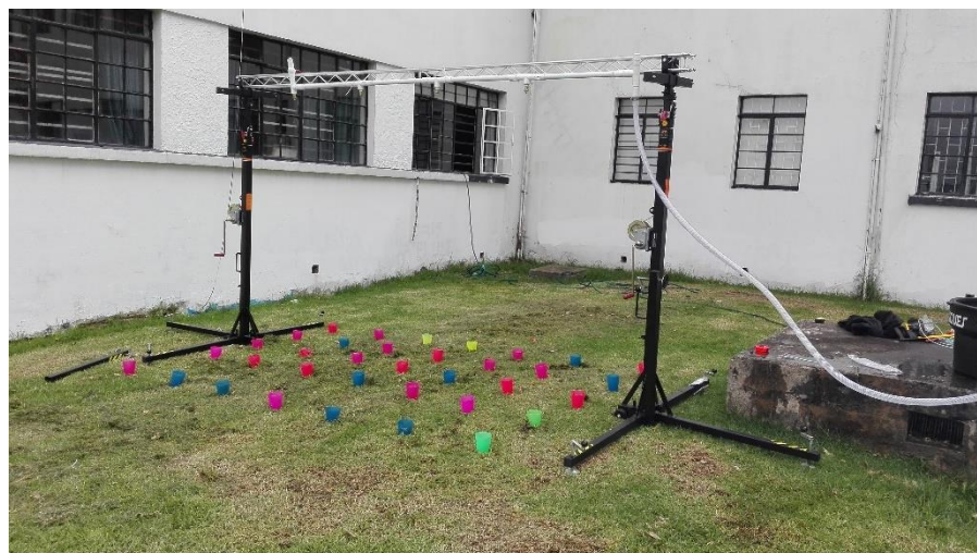
Figura 1-11: Estructura de soporte y primera configuración de emisores.
