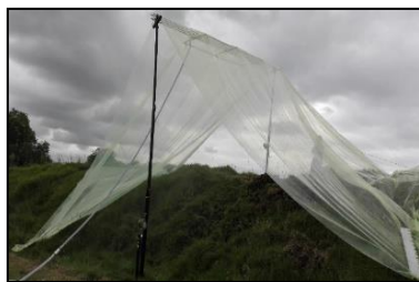
Figura 1-14: Primer diseño de barrero cortavientos probado en campo.
