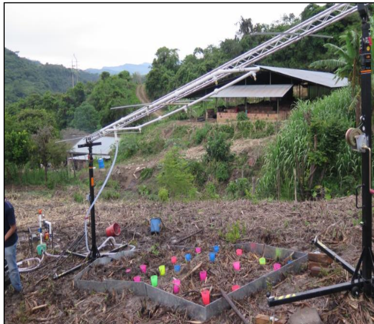
Figura 1-6: Prueba de uniformidad en una pendiente de 35%.
