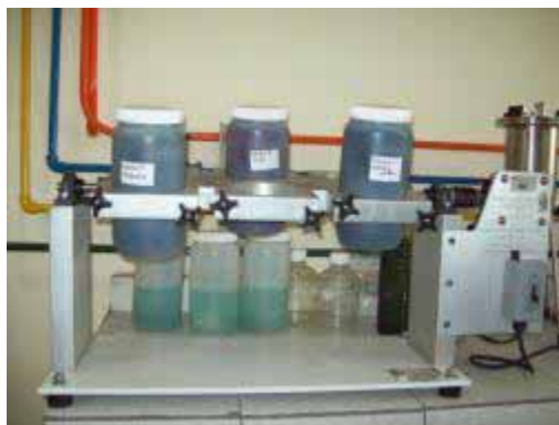
Figura 19. Equipo y muestras para TCLP.
