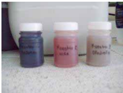
Figura 20. Extractos TCLP para análisis por absorción atómica.
