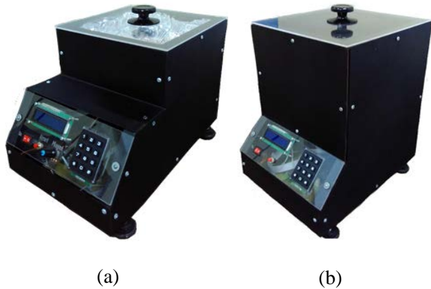
Figura 6. Prototipos finales (a) Spincoater. (b) Fuente de radiación UV. Fuente: Los autores.
