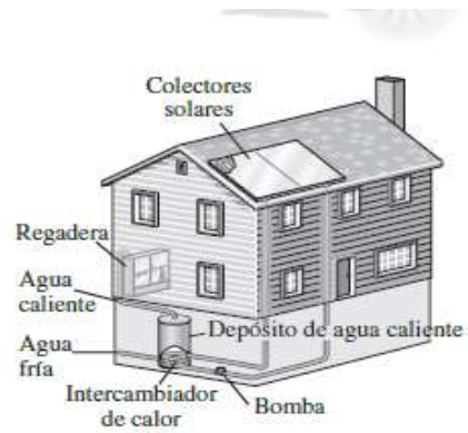
Figura 3.11 16 El diseño de muchos sistemas de ingeniería, como este sistema solar para calentar agua, tiene que ver con la termodinámica.
