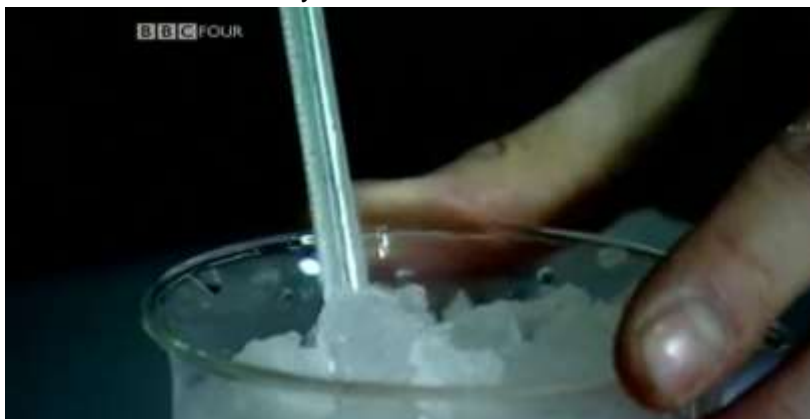
Figura 3.6 11 mezcla de hielo, agua y sal utilizada por Daniel Fahrenheit para sus 0 grados
