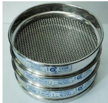
Figura 5.13 Sistema de tamices para análisis granulométrico de suelos. (Barbadillo & Perez, 2005)
