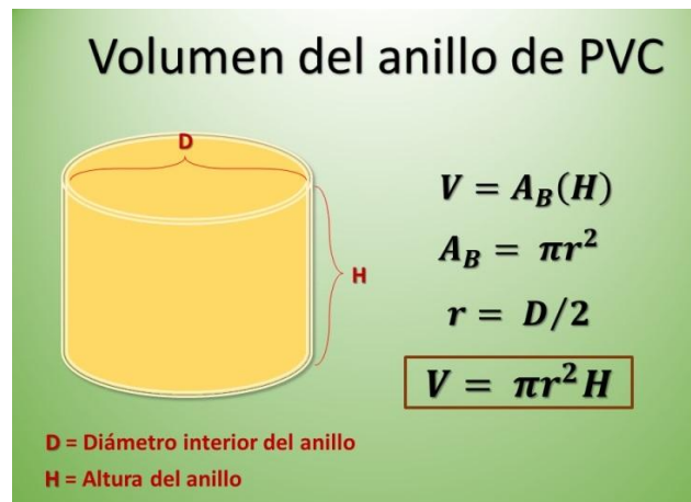
Figura 5.17 Calculo de volumen interno del anillo de PVC. Fuente: Autor
