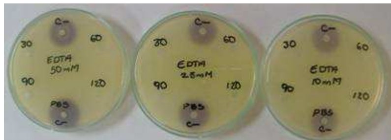
Figura 10. Efecto de agente quelante en la actividad de la enzima. El EDTA se evaluó en concentraciones de 50, 25 y 10 mM durante 30, 60, 90 y 120 minutos. (C-): solución de PBS 1X con EDTA y C6-HSL, las reacciones se terminaron a los 30, 60, 90 y 120 minutos de reacción. C-PBS, solución de PBS 1X con C6-HSL sin EDTA.
