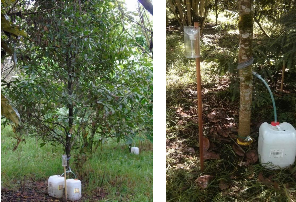
Figura 2-5: Instalación de collarines y pluviómetros en individuos plantados en la microcuenca San Pedro 6 .
