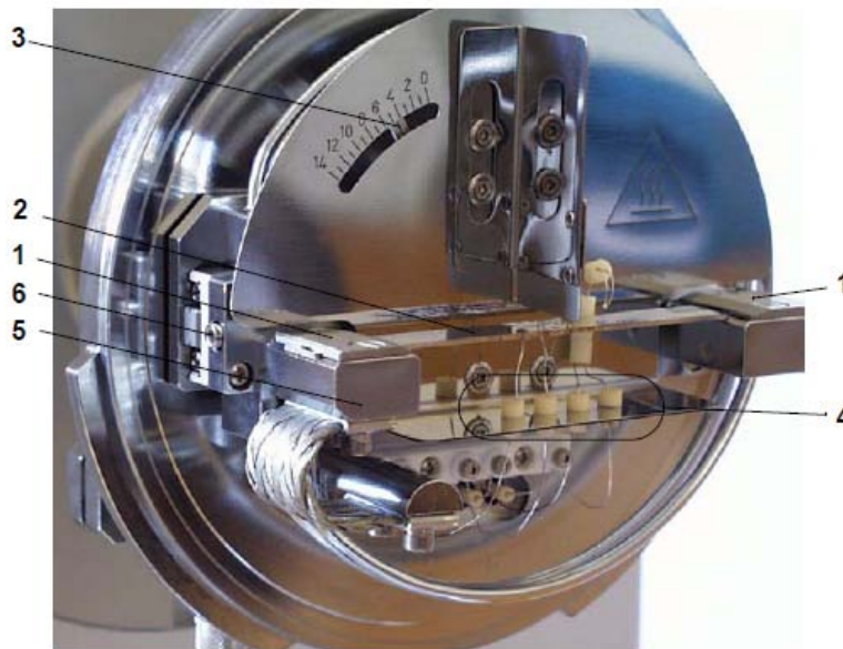
Figura 4.2. Cámara de calentamiento Anton Paar HTK16. 1) Mordaza de filamento de calentamiento. 2) Filamento de calentamiento. 3) Sistema para graduar la tensión del filamento. 4) Guía de termocuplas. 5) Bloque móvil para fijación de filamento 6) Tornillo para graduar tensión en el filamento.
