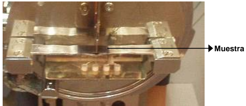
Figura 4.3. Posicionamiento de la muestra en la platina de calentamiento.
