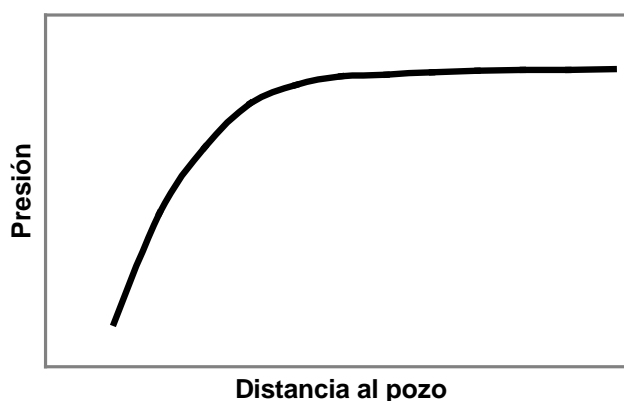
Figura 10. Curva típica de Presión Vs Distancia en un yacimiento de petróleo.
