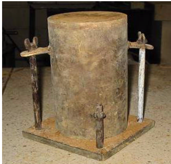
Figura 8. Molde compresión Inconfiada
