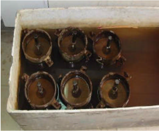
Figura 11. Curado muestras CBR de Cal
