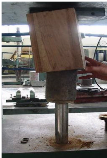
Figura 9. Extracción Probeta Compresión Inconfiada
