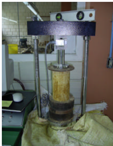
Figura 17. Ensayo de Compresión Inconfiada.
