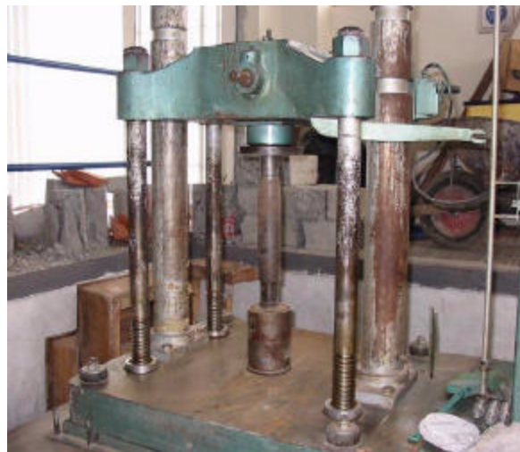
Figura 7. Aplicación Carga para elaboración briqueta.
