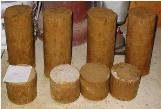
Figura 13. Muestras con 5% de Cal.
