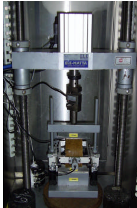
Figura 16. Ensayo de Tensión Indirecta
