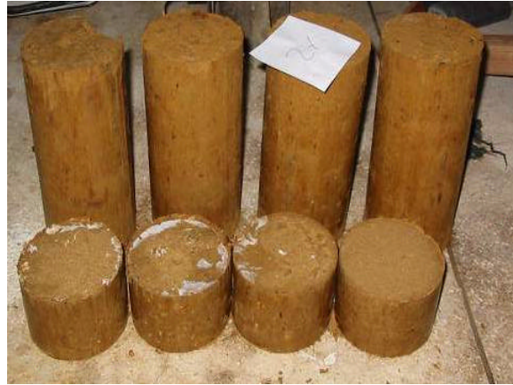
Figura 12. Muestras con 2% de Cal
