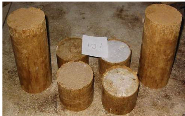
Figura 14. Muestras con 10% de Cal.
