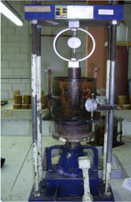
Figura 15. Ensayo de CBR.
