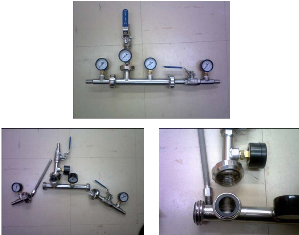
Figura 14. Dispositivo externo al tanque de fermentación soporte del difusor.
