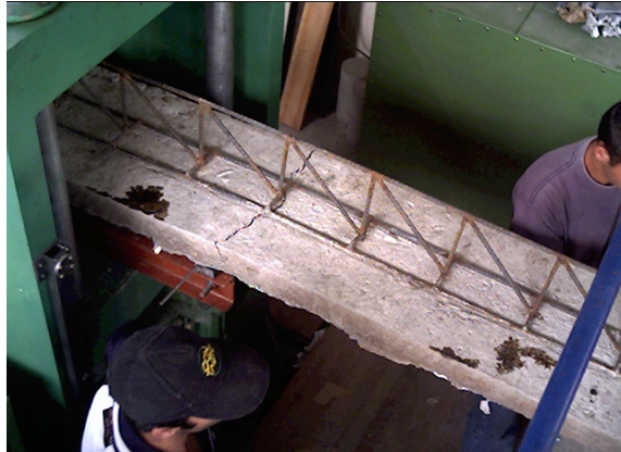
Imagen 17: Ensayo de vigueta compuesta con conectores de cortante.
