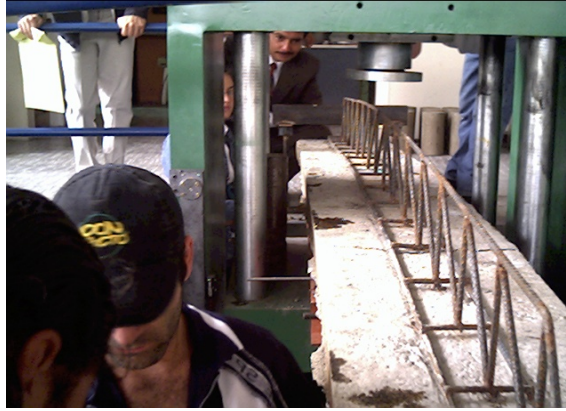
Imagen 10: Ensayo de vigueta compuesta con conectores de cortante.
