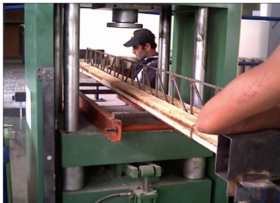
Imagen 12: Ensayo vigueta metálica muestra 1.
