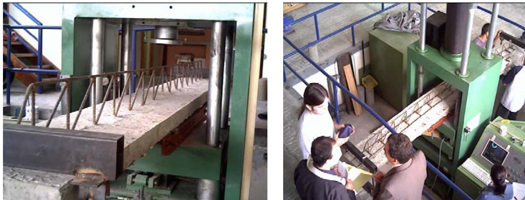
Imagen 8: Sistema de montaje de las vigas ensayadas en la máquina universal.
