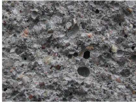
Figura 12 Apariencia microscópica del mortero sin adición de aditivo proteínico (30X) (9)
