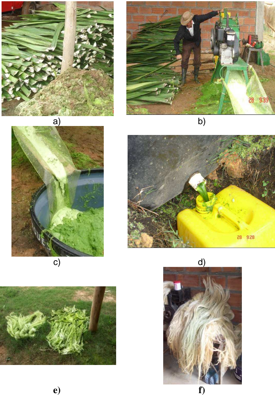
Figura 18 Proceso productivo del fique, a) Hojas de fique cortadas, b) Proceso de defibrado de la hoja, c) Bagazo residual del defibrado, d) Jugo residual del defibrado, e) Fibra de fique lavada, f) Fibra de fique seca
