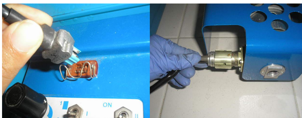
Foto 15. Conexión del pirolizador. Septiembre de 2008. Laboratorio de Cromatografía, Escuela de Química, Universidad Industrial de Santander
