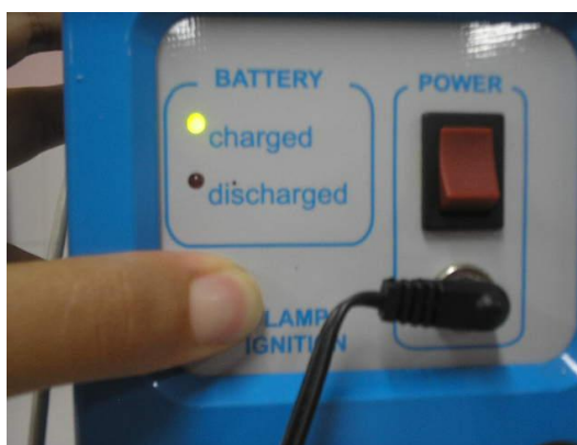
Foto 4. Encendido del RA-915+
