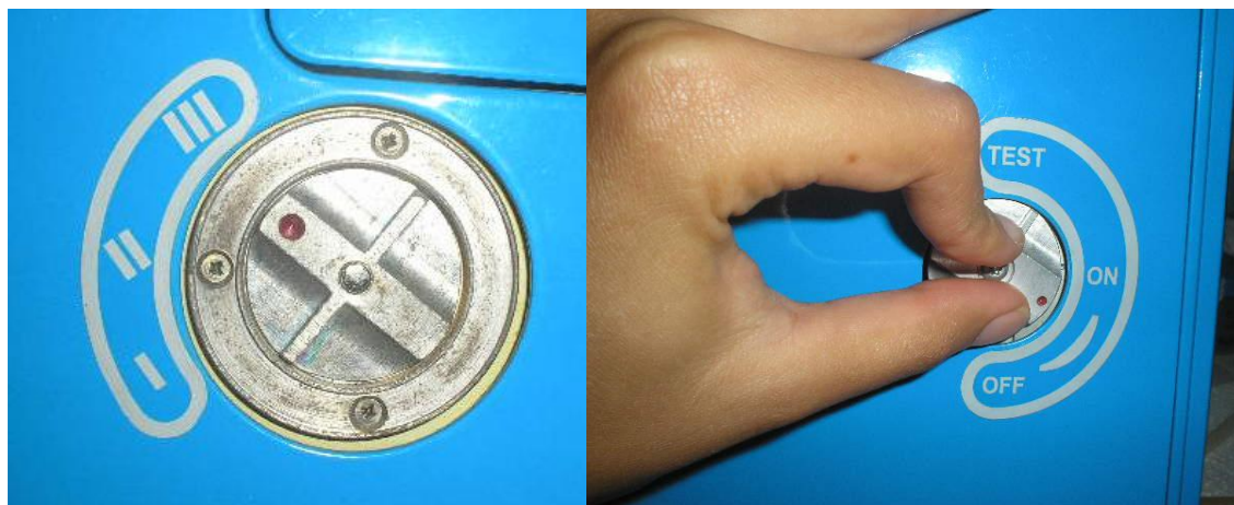
Foto 5. Fijación de posición III del puente óptico y celda Test, Septiembre de 2008. Laboratorio de Cromatografía, Escuela de Química, Universidad Industrial de Santander
