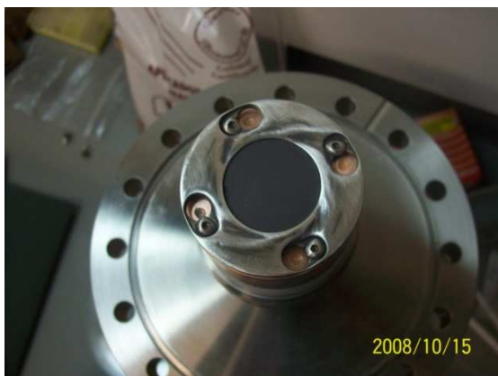
Figura 4: Blanco (pastilla negra) fijo en cátodo del sistema de pulverización catódica (Sputtering)
