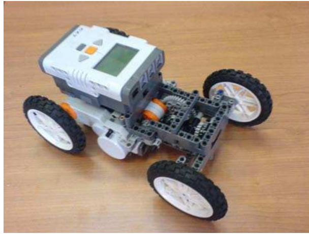
Figura 5.1: Sistema Construido: Vehículo Auto-Guido
