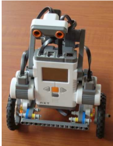
Figura 6.4: Sistema Construido: Segway
