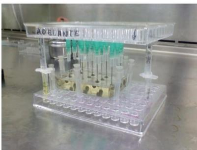
**Figura. 5-6** Equipo de captura y recubrimiento de núcleos (CRN) fabricado y construido Universidad nacional de Colombia, Instituto amazónico de Investigaciones científicas Sinchi (Autor).
