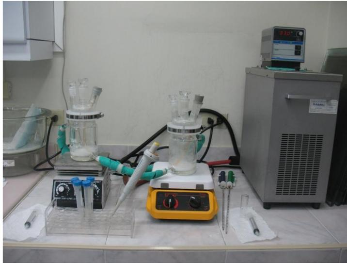
**Figura. Anexo A.1** biorreactor enchaquetado con acoplamiento a un recirculador de agua y agitación magnética
