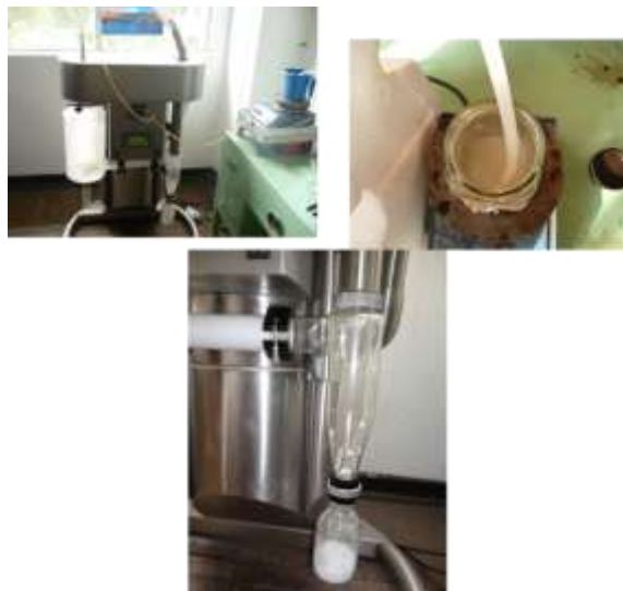
Figura 2-3: Microencapsulación por secado por atomización “ Spray Drying ” de compuestos antioxidantes
