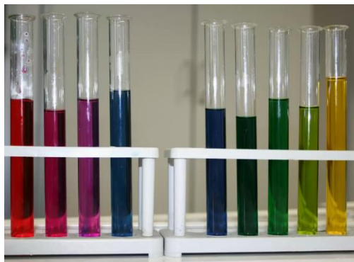
Figura 3-7 Indicador de pH en soluciones ácidas, neutras y alcalinas. Gráficos tomados de http://acidosybases01.blogspot.no/
