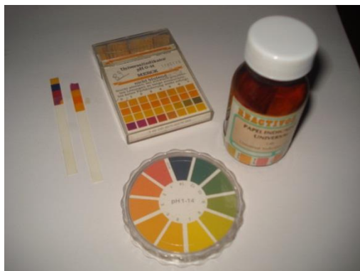
Figura 3-8 Comportamiento de los ácidos y bases en papel indicador. Fotografía del autor.
