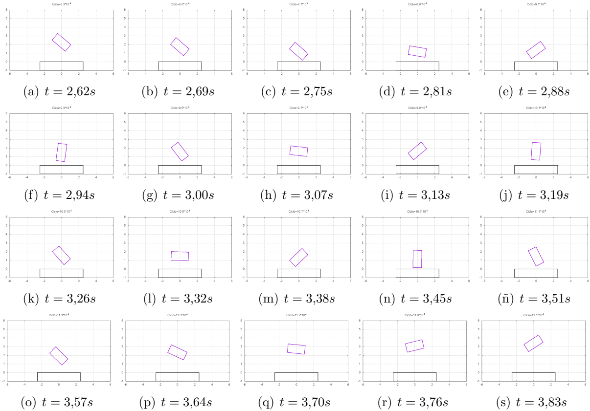
Figura 2-17.: Animación del rebote elástico con rotación, E = 20GPa
