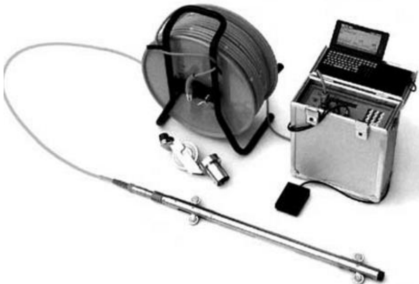
Figura 6-8. Sistema de instrumentación Inclínómetro. Adaptado: http://muchik.com/que-es-un-inclinometro .
