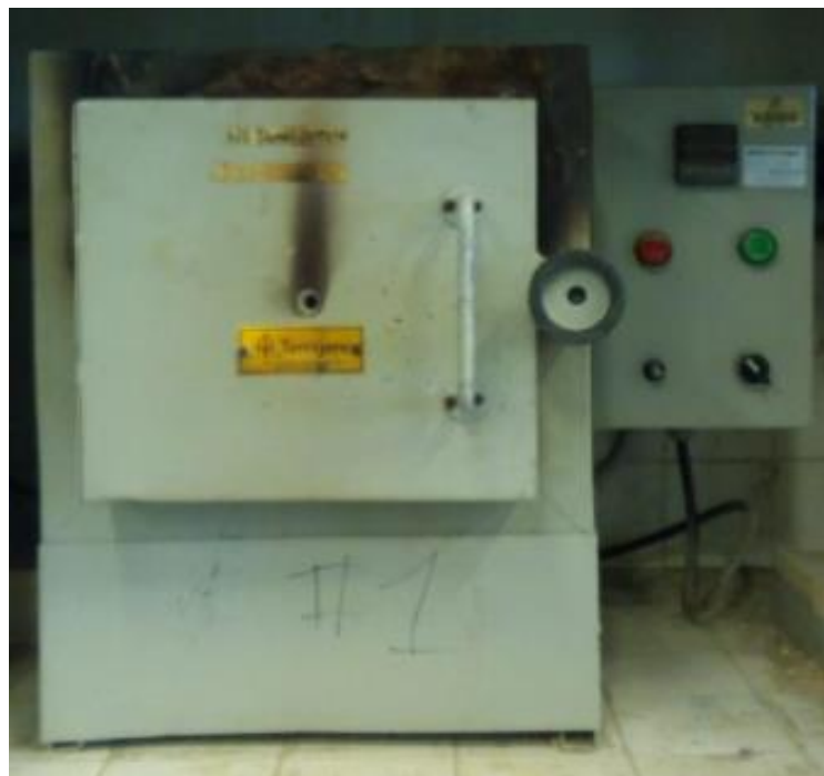
Figura. 11 Mufla para el tratamiento térmico de las zeolitas naturales.
