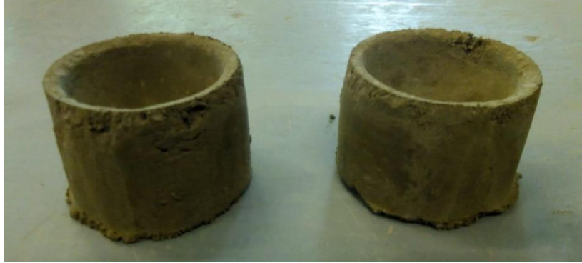
Figura. 12 Crisoles para tratamiento térmico de las zeolitas naturales.
