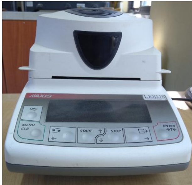
Figura. 15 Termo balanza para medición de cantidad de agua.
